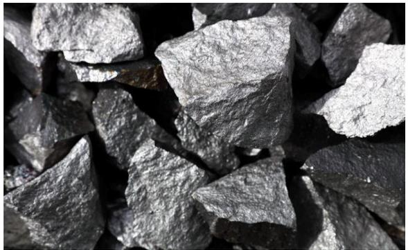
铁合金冶炼业务现有内蒙古、青海两大低碳硅基合金生产基地，产品销往 20 多个国家及地区，产品被广泛应用于特钢工业以及其他工业生产中。铁合金冶炼业务是指利用硅石、锰矿石、兰炭、球团矿、白云石和电极糊等原材料，由自备电厂提供电力，进行精炼硅铁、高纯硅铁、硅锰合金等铁合金产品的冶炼，产品主要销往钢铁冶炼及金属镁厂商。
